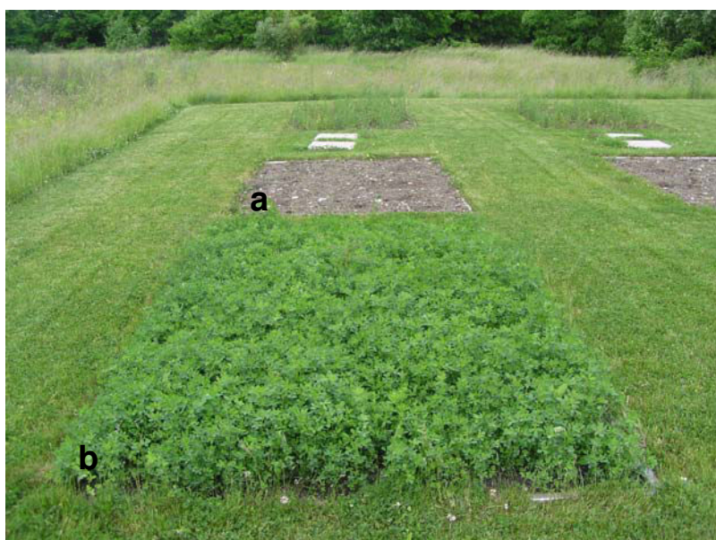
Figure 10 : Photographie des parcelles lysimétriques de grands volumes avec le sol de Neuves-Maisons. Modalités sol nu (a) et végétation spontanée (b).
