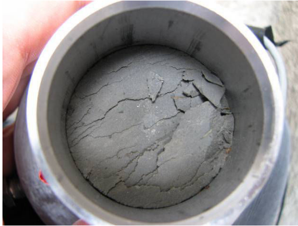
Figure 4.11 : Fracturation superficielle de l'échantillon ANDRA EST 26485
