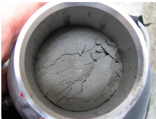
Figure 4.11 : Fracturation superficielle de l'échantillon ANDRA EST 26485
