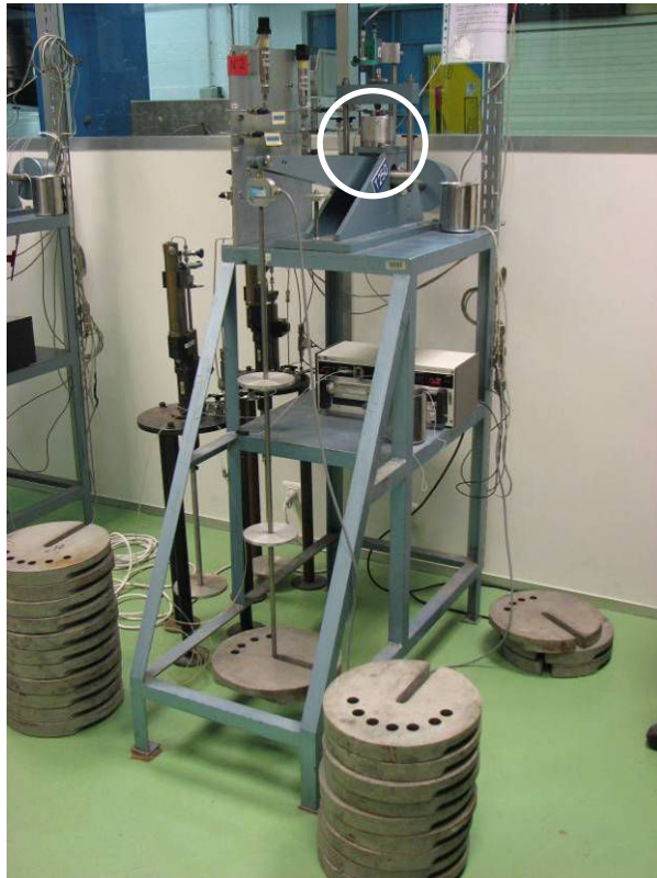
Figure 4.1 : Descriptif d'un œdomètre
