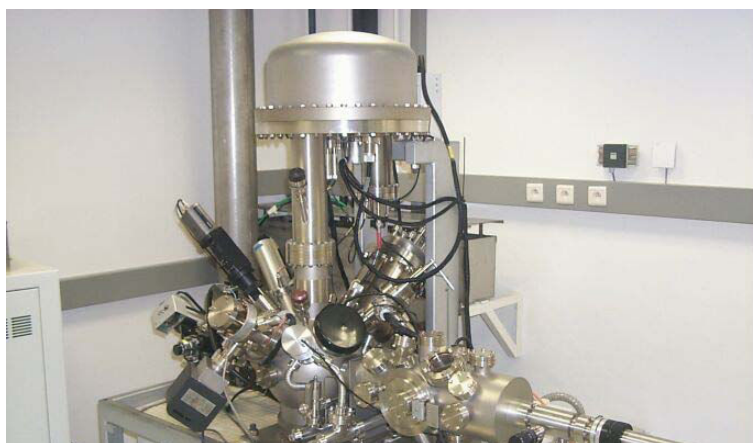
Figure A-7 Dispositif expérimental XPS : Thermo VG Microlab350 au CRPGL.
