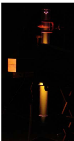
Figure IV-11 Post-décharge d'un plasma micro-ondes Ar/N 2 à la pression atmosphérique à 500 W avec un débit d'argon de 10 Nlm et un débit d'azote de 1 Nlm.
