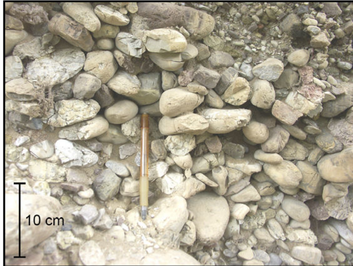
Figure 4.23 : Texture «open-framework» dans l'association de faciès de foreset de SU8 en zone 2E (Fig. 5.3.b).
