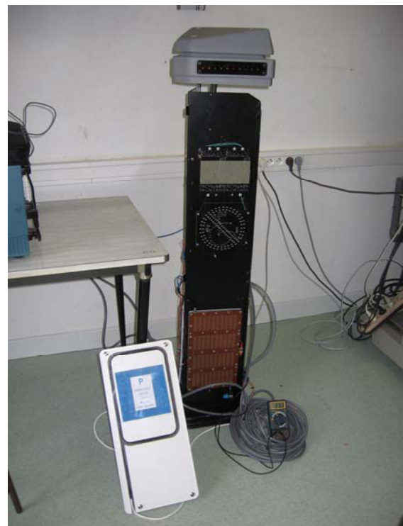
Figure 4-27 : Intégration de l'électronique de puissance et des piles PAXITECH dans la borne de stationnement TECHNOLIA.
