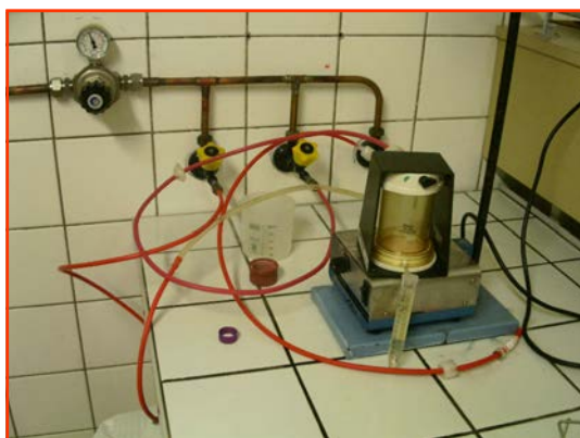
Figure 35 – Système d’ultrafiltration pour l’élimination de l’enzyme et l’obtention des produits d’oxydation de l’acide gallique.
