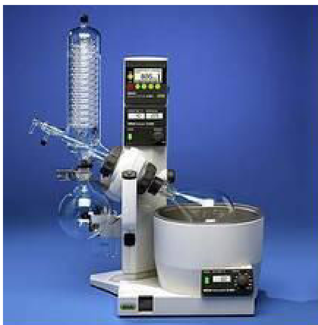
Figure 41: Evaporateur rotatif utilisé pour les synthèses sous pression réduite
