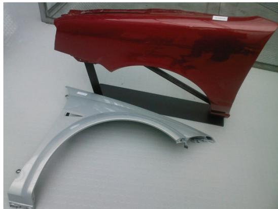
Figure 0.2 : Photographie d'une aile de voiture peinte avant et arrière en SmooSteel™ produite par ArcelorMittal.
