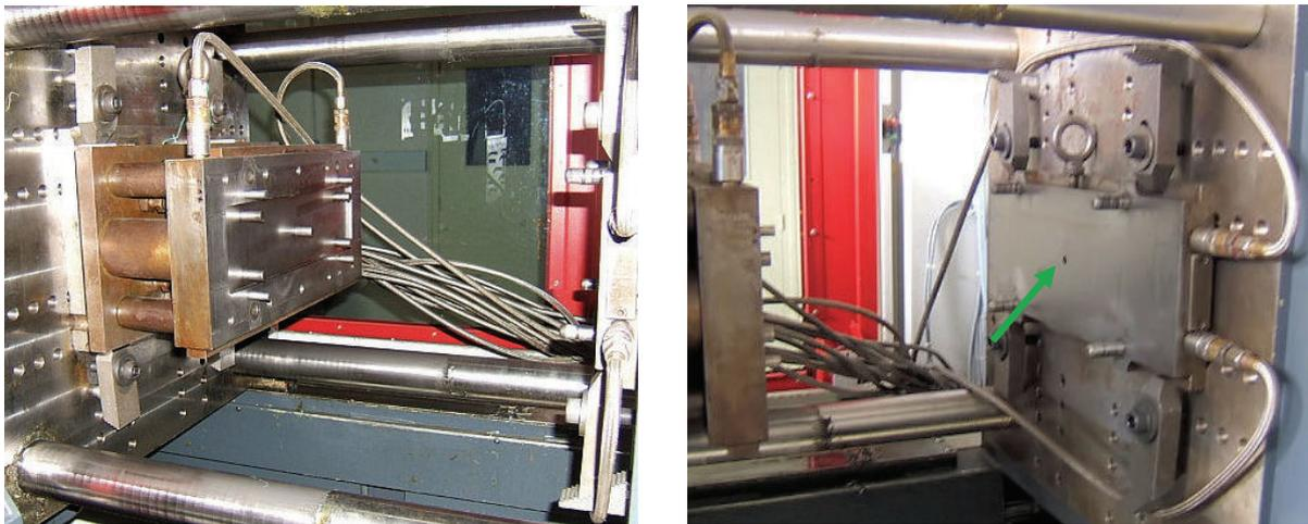
Figure 3.2.5 : Moule d'injection utilisé au CRITT Polymères Picardie pour la mise en forme des plaques de PP/EPR chargé par des particules minérales ( $\text{CaCO}_3$  et  $\mu$ -talc). La flèche indique le point de remplissage.
