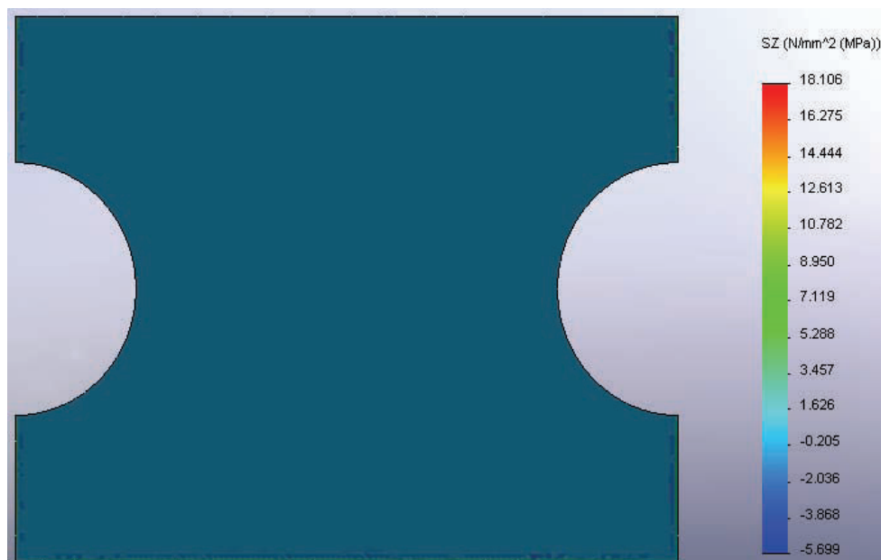
Figure H.7 : Représentation des contraintes selon l'axe 2 au sein d'une éprouvette sollicitée en traction uniaxiale.
