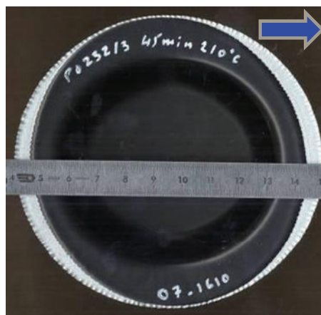
Figure 0.8 : Observation sur un flanc pré-embouti du retrait de la couche organique du SmooSteel™ après l'application du procédé de cathodisation.
