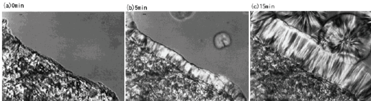
Figure A.24 : Observation du développement de la transcristallinité à T = 135^{\circ}\text{C} (Naiki et al. (2001)). 50\ \mu\text{m}
