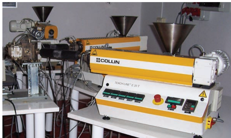
Figure 3.2.6 : Système COLLIN de co-extrusion à dimension laboratoire pour l'élaboration de films polymères bicouches (Ponçot, 2006).
