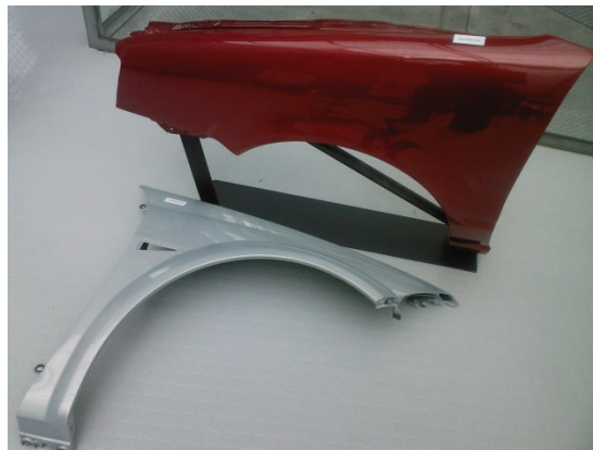
Figure 0.2 : Photographie d'une aile de voiture peinte avant et arrière en SmooSteel TM produite par ArcelorMittal.
