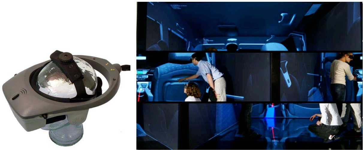
Figure 25 : Exemple de systèmes d'immersion : A gauche une Visiocasque 47 , à droit CAVE™ de PSA Peugeot Citroën 48 .
