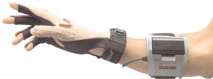
Figure 26 : Exemple de gant de données CyberGlove®.
