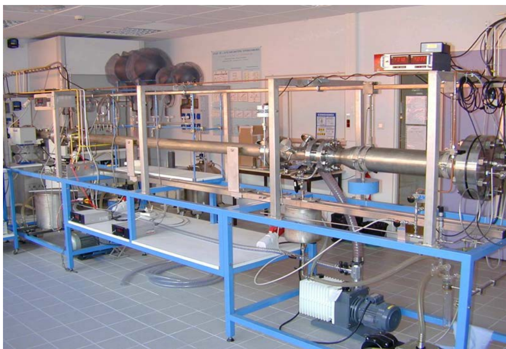
Figure II.3 : Photographie du tube à onde de choc et de son environnement proche.
