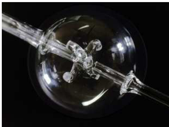
Figure II.10 : Réacteur auto agité par jets gazeux.
