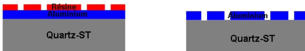
*Figure IV-12 : Gravure humide du film d'aluminium (gauche), structure finale de l'échantillon après élimination du masque de résine (droite)*
