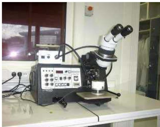
Figure IV-17 : Photo de l'appareil de bonding
