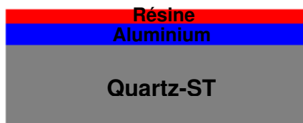
Figure IV-9 : Structure après dépôt de la couche de résine
