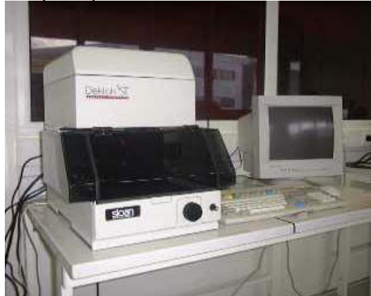
Figure IV-7 : Photo du profilomètre mécanique utilisé pour mesurer l'épaisseur des couches minces
