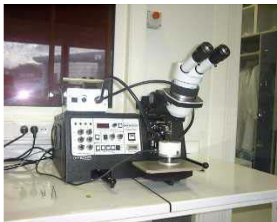
Figure IV-17 : Photo de l'appareil de bonding
