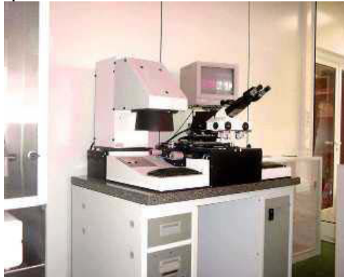
Figure IV-10 : Photo de l'insolateur MA 750
