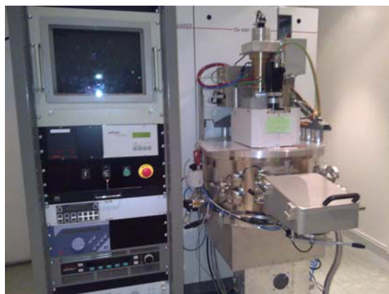
Figure IV-4 : Photo du bâti de pulvérisation cathodique magnétron DP 650 utilisé pour le dépôt des couches minces de ZnO.
