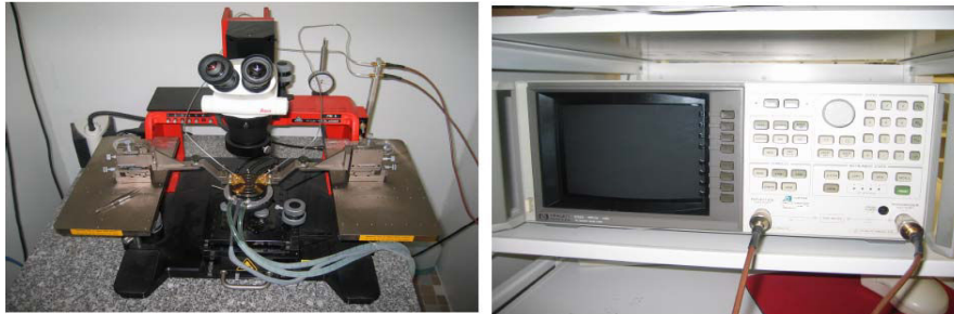
Figure IV-14: Testeur sous pointes Karl Suss PM5 (à gauche) et un analyseur de réseau HP8752A (à droite)
