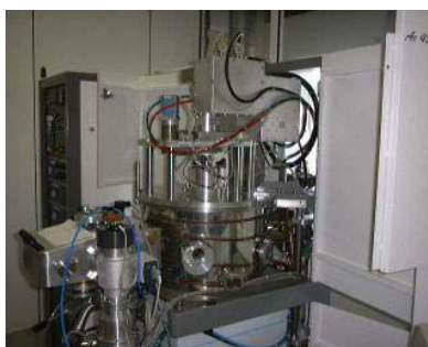
Figure IV-3 : Photo du bâti de pulvérisation cathodique magnétron AC 450
