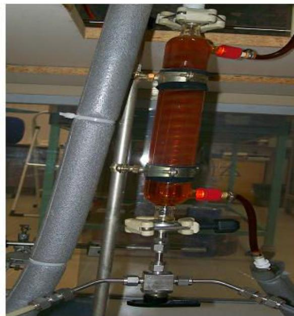
**Figure II.8: Colonne de séparation et vanne à trois voies.**
