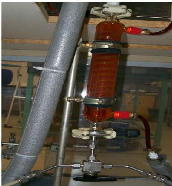
Figure II.8: Colonne de séparation et vanne à trois voies.
