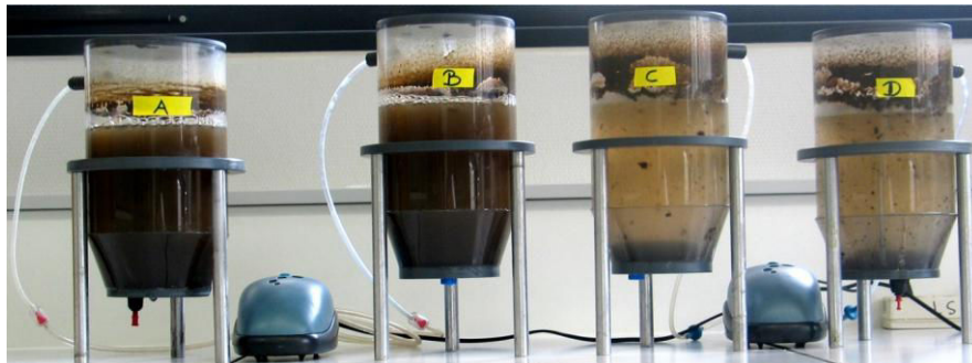
Figure 2-3 : photographie des quatre réacteurs batch 3L prise 24h après le début d'une expérience avec la boue et l'eau usée d'Epinal. De gauche à droite : réacteur témoin, 1 mg/L d'érythromycine, 10 mg/L d'érythromycine, 20 mg/L d'érythromycine.
