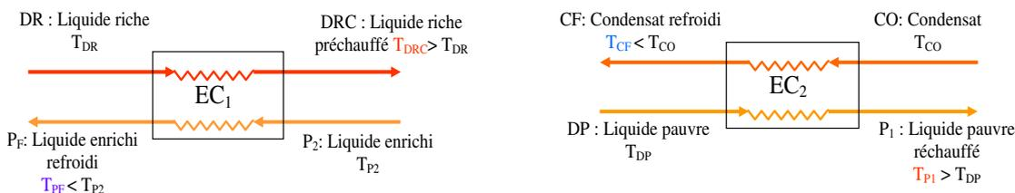
Figure 12 : Rappel des configurations des 2 échangeurs
