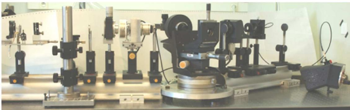
FIGURE 2.10 – Ellipsomètre spectroscopique temps réel à compensateur tournant.
