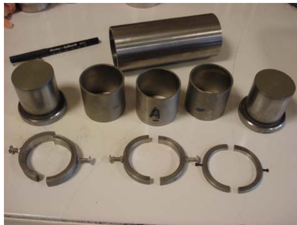
Figure 2.11 : Équipement de compactage des éprouvettes
