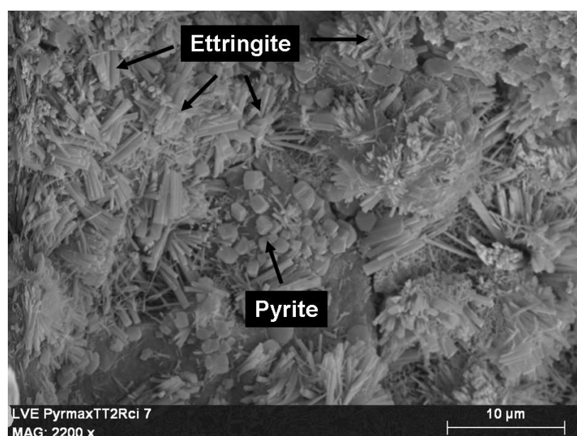
Figure 4.29 : Observation de surface au MEB du mélange limon + FeS 2 + CaO + CEM II, détail de la présence résiduelle de pyrite et de la formation d'ettringite (×2200)
