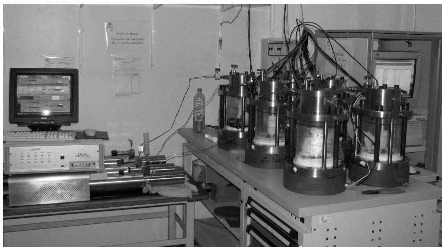
Figure III-4 : Dispositif expérimental : cellules de fluage montées en série.
