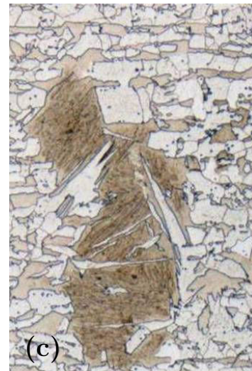
Fig. 4.3 – Micrographies (ferrite en clair) illustrant les deux types de morphologie observés dans [92].
