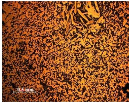
Figure 71. Micrographie d'un échantillon de titane nitruré.
