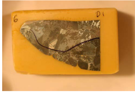
Figure 52a. Exemple de coupe verticale d'un bouton solidifié de TA6V et de localisation à posteriori de l'interface entre le bain liquide et le talon de métal solide.
