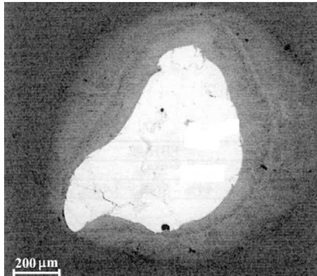
Figure 3. Inclusion de tungstène pur retrouvée dans une billet de TA6V [11].
