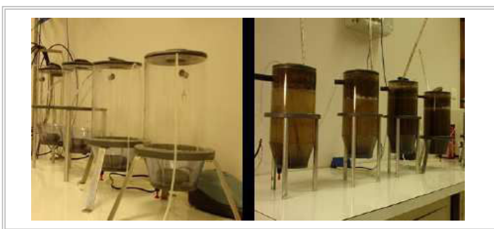
Figure II.4. Réacteurs batch de 4 L utilisés dans l'expérimentation avec les antibiotiques.
