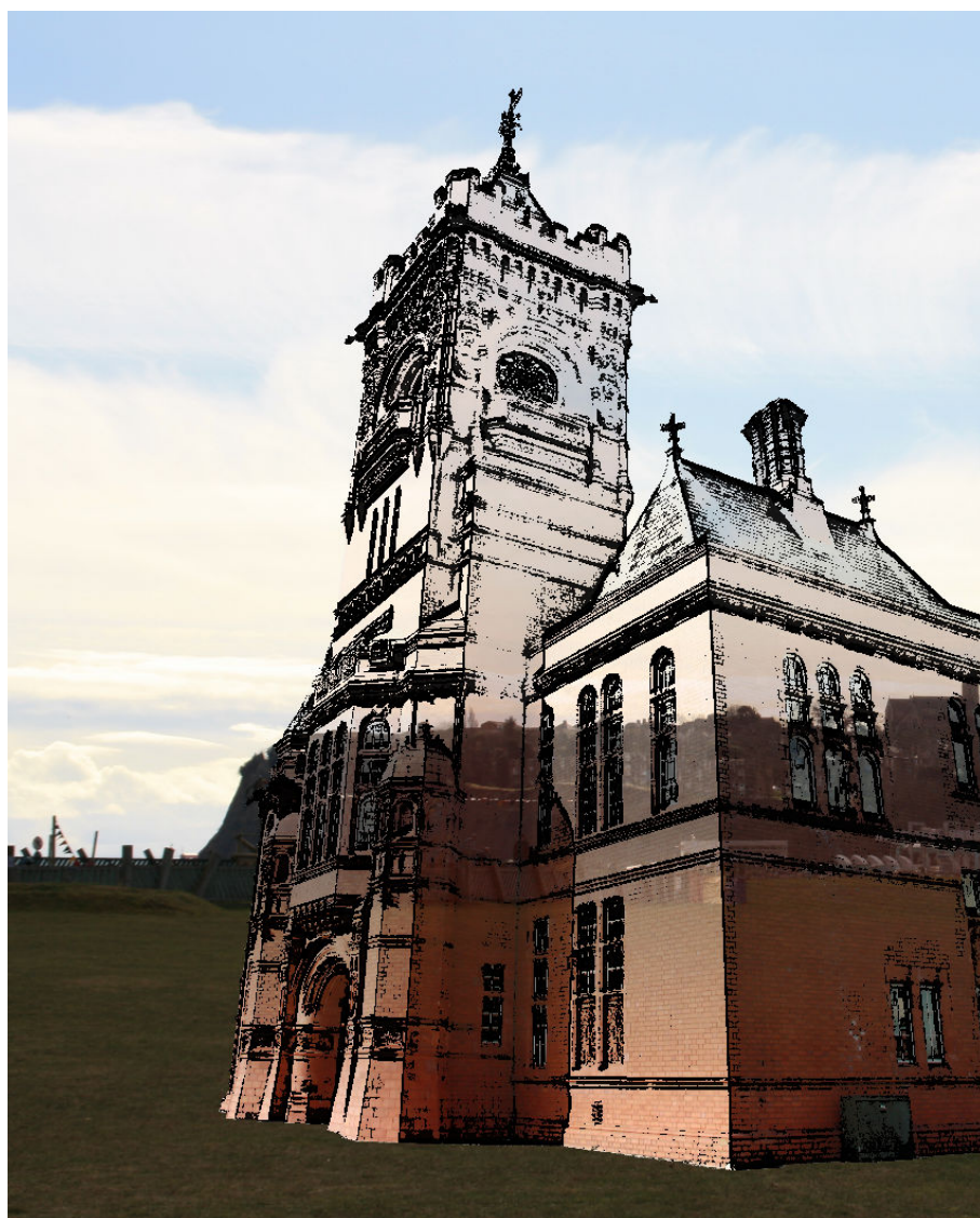
Fig. 2.10 – Visualisation des incertitudes sur l'architecture d'un bâtiment en archéologie. Les incertitudes croissent entre les fondations et le sommet de la reconstitution du bâtiment. Adapté d'après Strothotte et al. (1999).
