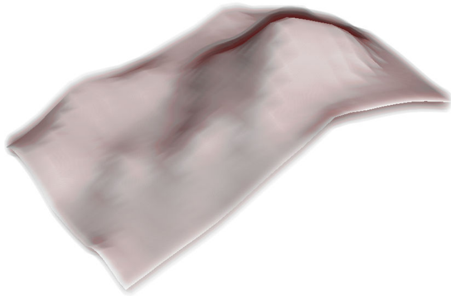
Fig. 2.12 – Visualisation d’une couche géologique avec enveloppe d’incertitude sur la position de la couche. L’enveloppe d’incertitude englobe l’ensemble des positions que la couche peut occuper.
