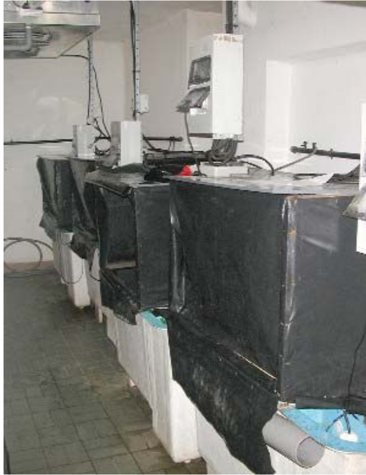
Figure 12 : Salle climatisée et bacs de 500L couverts par une bâche de polyéthylène.
