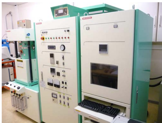
Figure 18 : SPS Dr Sinter 515S de SPS Syntex Inc. installé à l'IJL
