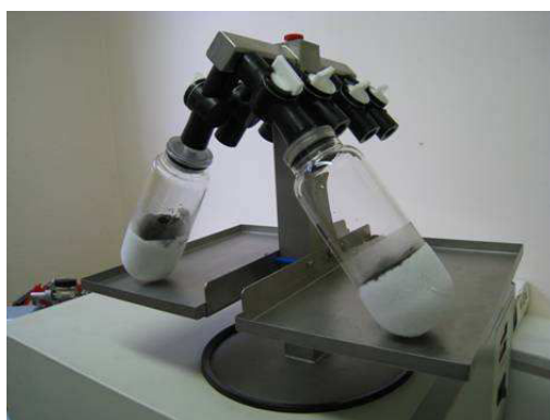
Figure 13 : Lyophilisateur utilisé pour sécher les poudres. Les flasques cryogéniques ont été plongées dans l'azote liquide pour solidifier le contenu avant d'être installée sur le système
