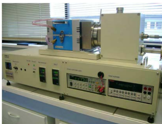
Figure 11 : Photographie du dispositif de mesure ZEM-3 (Laboratoire CRISMAT de Caen)
