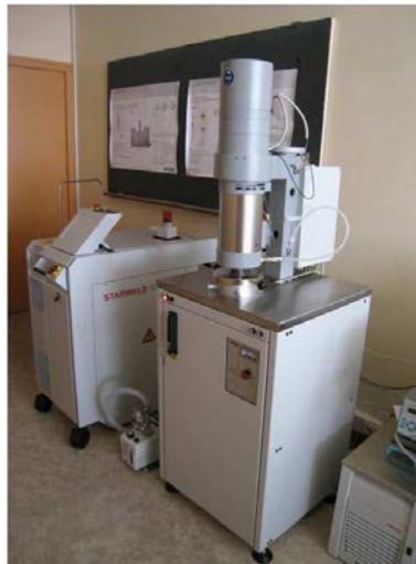
Figure 8 : Photographie du dispositif de mesure de la diffusivité thermique (LFA 427 Netzsch)
