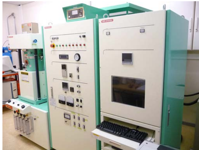
Figure 18 : SPS Dr Sinter 515S de SPS Syntex Inc. installé à l'IJL
