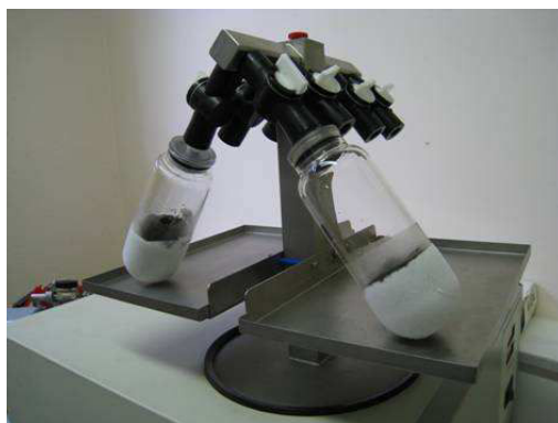
Figure 13 : Lyophilisateur utilisé pour sécher les poudres. Les flasques cryogéniques ont été plongées dans l'azote liquide pour solidifier le contenu avant d'être installée sur le système
