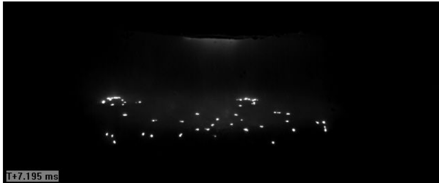
(a) Vue sur la surface de la cathode (N=16 – filtre 0,5%).
