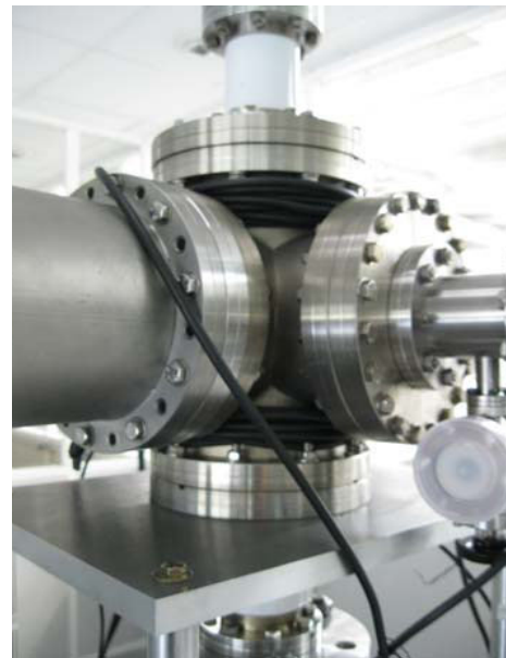
Figure 3.3 Montage des bobines de Helmholtz sur la maquette.
