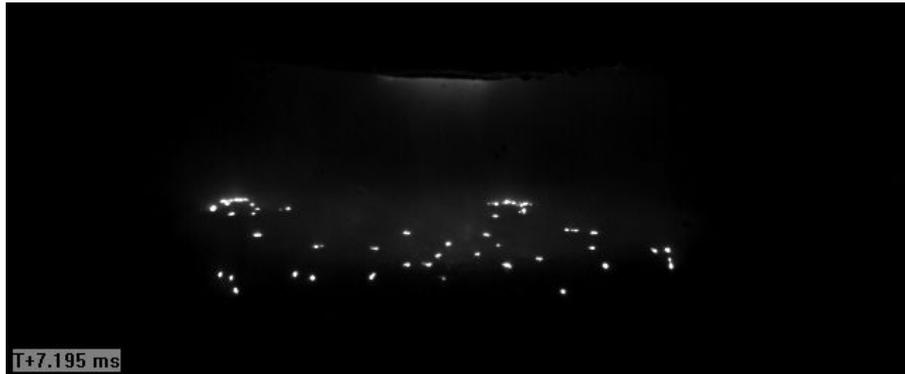
(a) Vue sur la surface de la cathode (N=16 – filtre 0,5%).
