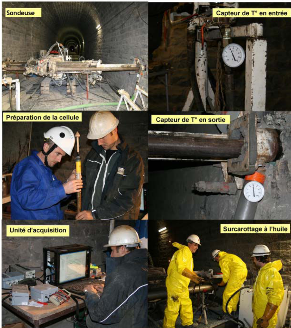
Figure 47 : Photographies des essais de surcarottage – Campagne de 2008
