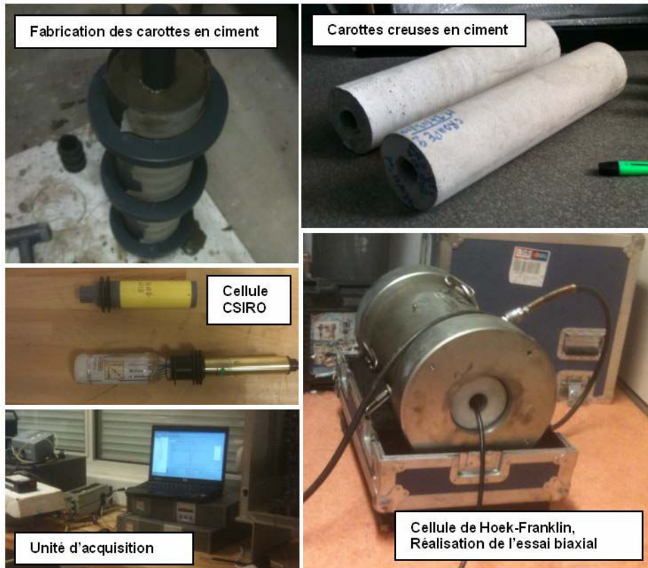
Figure 68 : Fabrication des carottes creuses en ciment et déroulement des essais biaxiaux.
