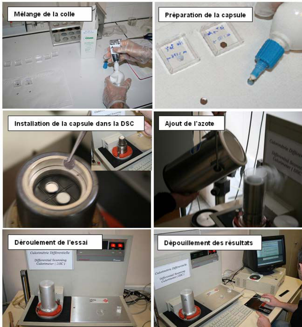
Figure 60 : Déroulement de l'essai de calorimétrie différentielle (DSC)
