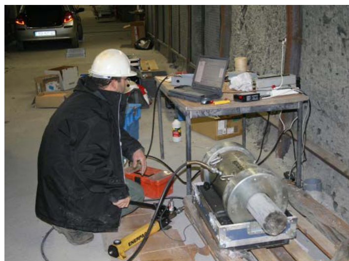
Figure 48 : Réalisation des essais biaxiaux dans la galerie Ouest
