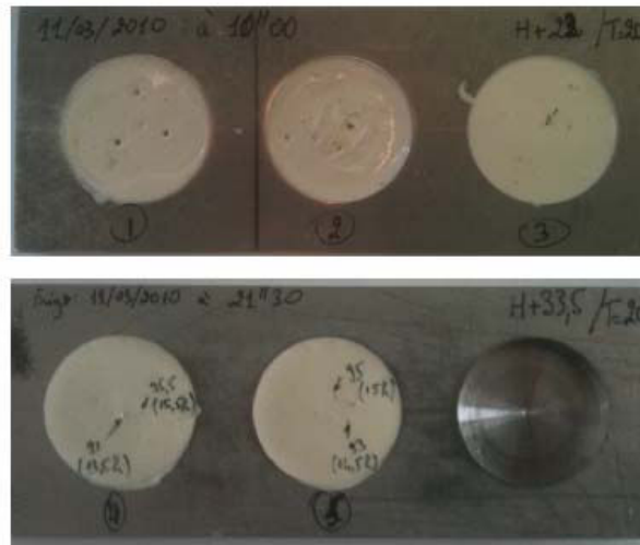
Figure 65 : Plaques d'aluminium contenant les échantillons de colle testé lors des essais « Shore A »
