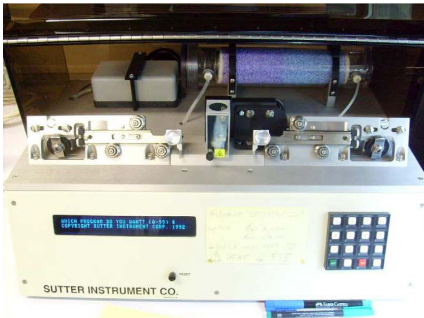
Figure 43 : L'étireuse de micropipette. Son rôle est de transformer un capillaire de verre en deux micropipettes symétriques, obtenues par chauffage intense de la zone médiane du capillaire et étirement.
