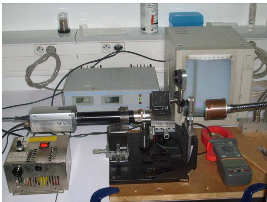
Figure 44 : La forge : son rôle est le dimensionnement précis de la micropipette après sa fabrication dans l'étireuse.
