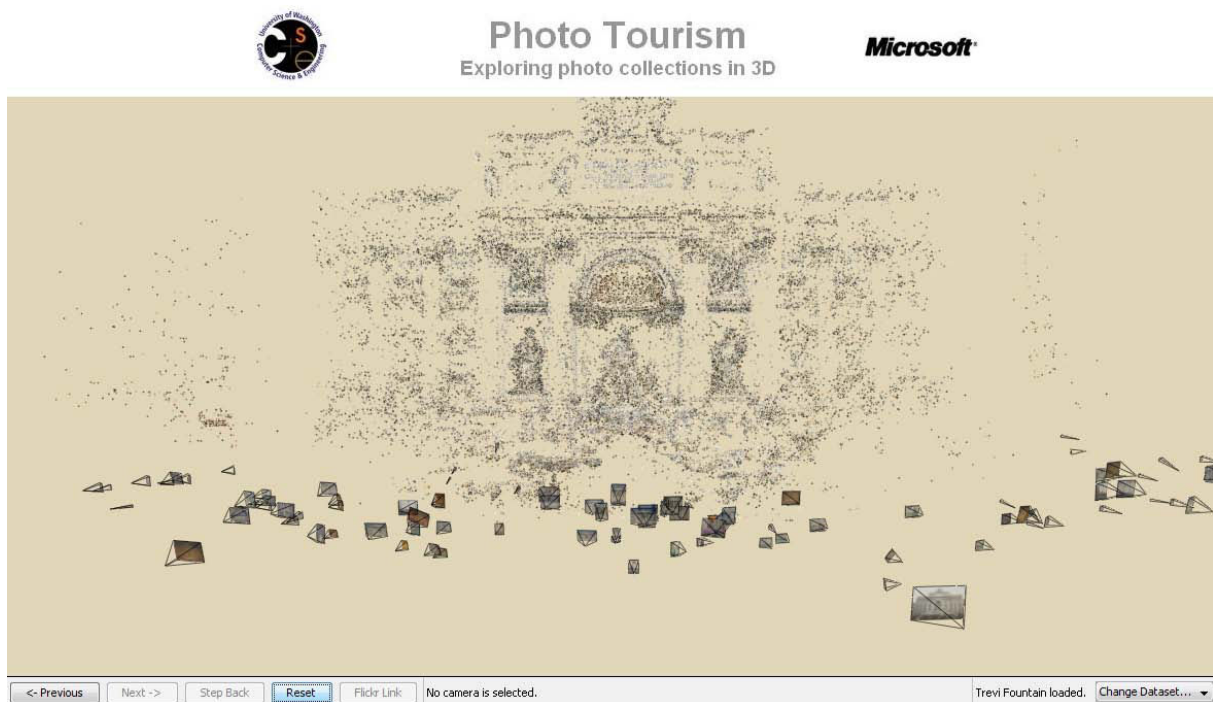
Figure 5. Reconstitution 3D de la Fontaine de Trevi à Rome à partir des photographies touristiques traitées par Photo Tourism 10 . Graphics and Imaging Laboratory , Washington.
