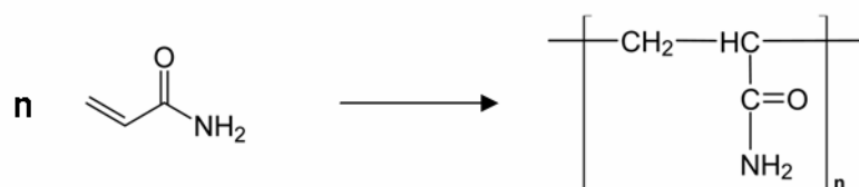
Figure VIII-2. Réaction de polyaddition vinylique de l'acrylamide en polyacrylamide.
