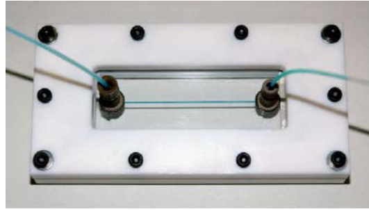
Figure 36 : Microréacteur photocatalytique mono-canal droit (Y. Matsushita et al., 2008).
