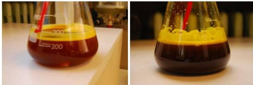
Figure IV. 2 : Le processus de préparation de la solution des réactifs (photo à gauche : Solution après ajout du sel \text{Fe}^{3+} ; photo à droite : Solution après ajout du sel \text{Fe}^{2+} )
