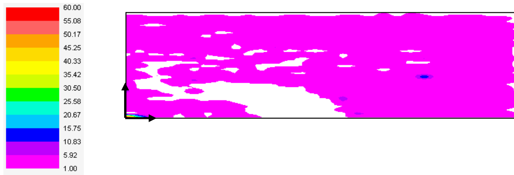
Figure 1 : distribution de particules sur le plan de sortie lorsque les forces sont activés pour le cas où la coulée est sans sac de distribution.
