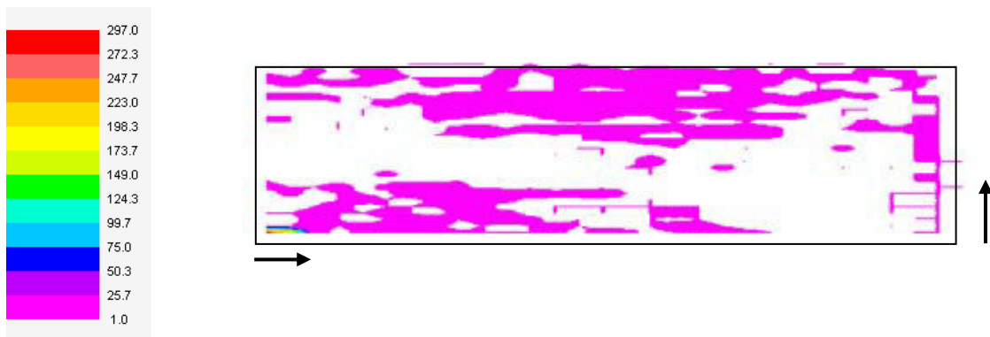
Figure 2 : distribution de particules sur le plan de sortie lorsque les forces sont activés pour le cas où la coulée est avec sac de distribution.
