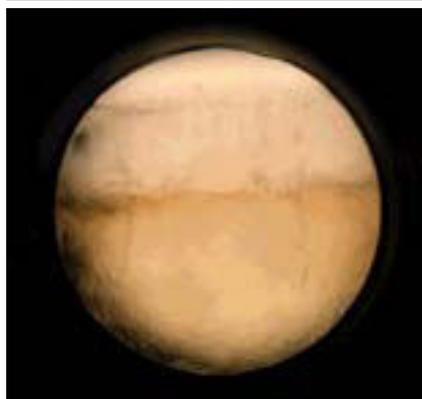
Les densités des phases gaz et liquide se rapprochent en raison de l'augmentation de la température. Le ménisque se trouble.
