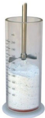
Figure 40 . Pale du rhéomètre FT3 dans l'éprouvette
