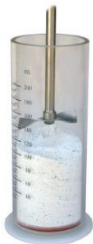
Figure 31. Pale en forme d'hélice descendant dans l'éprouvette du FT3 ( www.freemantech.co.uk )
