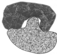
Figure 5. Agglomération par imbrication mécanique d'après Pietsch [5].
