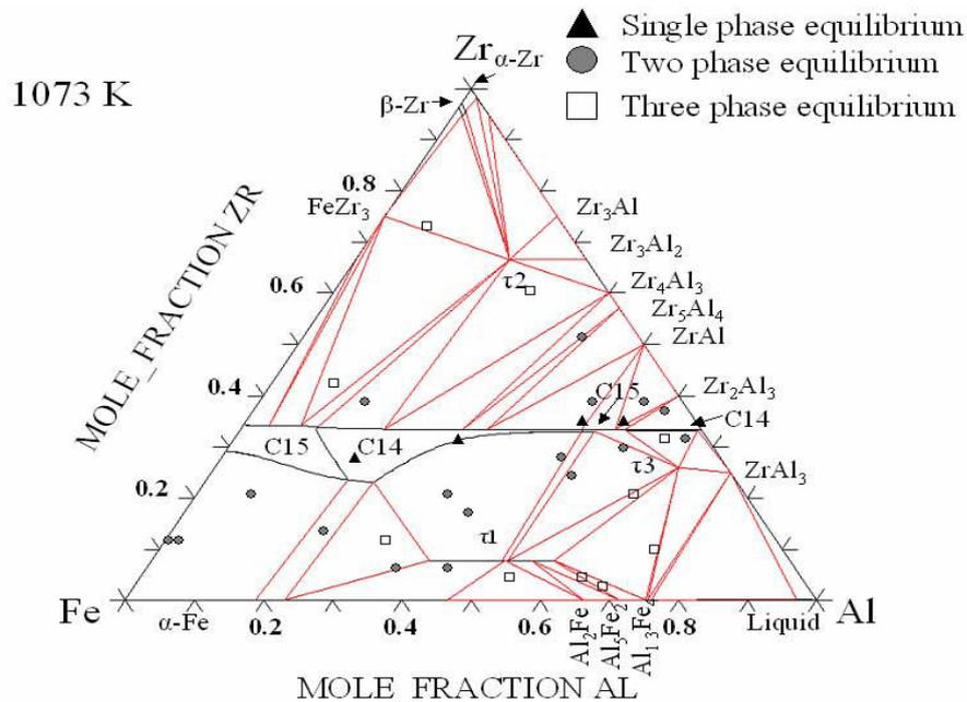
Figure VI - 3 - Section isotherme calculée à 1073 K du système ternaire Fe-Al-Zr, comparée aux données d'équilibres de phases déterminées expérimentalement symbolisées par  $\circ$ ,  $\Delta$  et  $\square$ .
