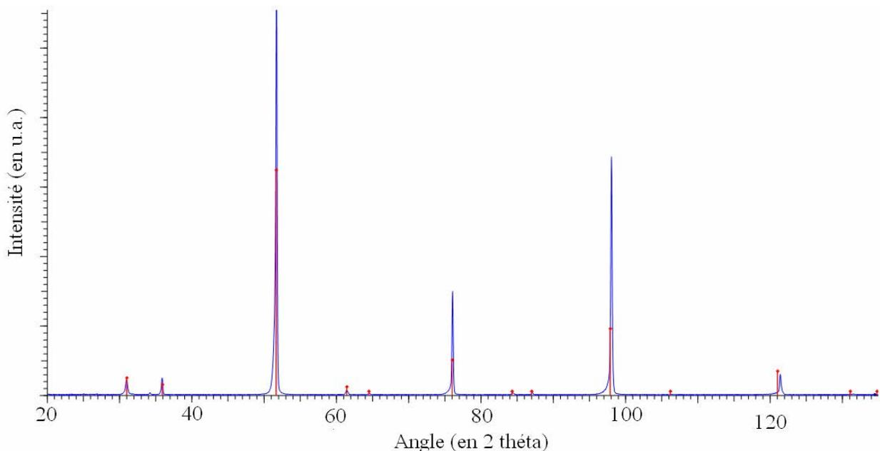
Figure III - 4 - Cliché de diffraction des rayons X caractéristiques des alliages Fe-25Al-xTi. Les pics correspondent à la solution solide ferritique  $\alpha$ -(Fe,Al,Ti) présentant une mise en ordre de type D0<sub>3</sub>.
