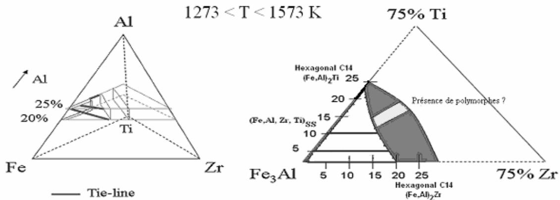
Figure V - 10 - Représentation tri-dimensionnelle du coin riche en fer du diagramme de phase quaternaire Fe-Al-Ti-Zr et projection des résultats sur une section isoplèthe à 25 at.% d'aluminium.
