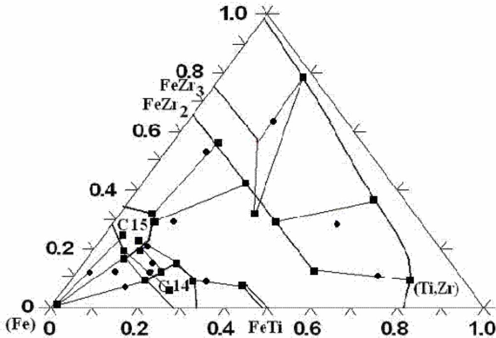
Figure V - 16 - Section isotherme à 1073 K déterminée expérimentalement. Les ronds représentent les compositions mesurées des alliages élaborés. Les carrés représentent les compositions chimiques des phases identifiées. Les traits entre ces symboles représentent les conodes et les traits en gras les propositions de limite des domaines des phases à 1073 K.
