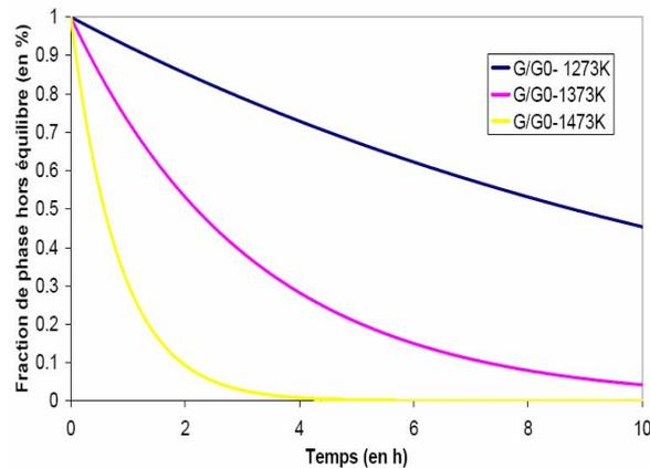
Figure V - 8 – Estimation de l'évolution de la fraction de phase hors équilibre calculée à l'aide du modèle de Flemings [FLE1974] en considérant le zirconium ou le titane comme élément limitant la diffusion. Le coefficient de diffusion utilisé est celui de l'aluminium dans un alliage  $Fe_3Al$  divisé par cent.
