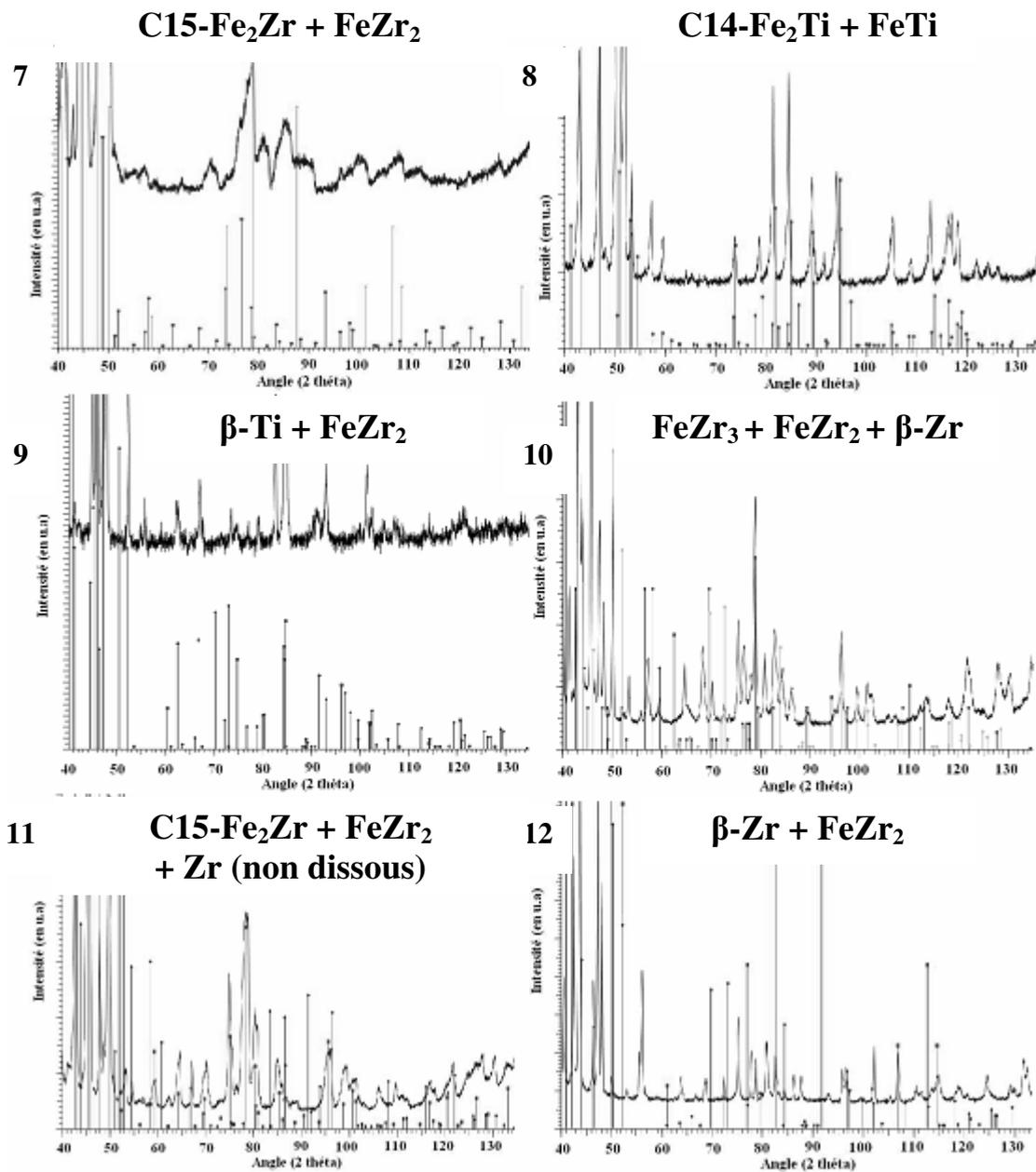
Figure V - 15 - Clichés de diffraction des rayons X des échantillons 7 à 12 après maintien isotherme à 1073 K suivi d'une trempe à l'eau salée.
