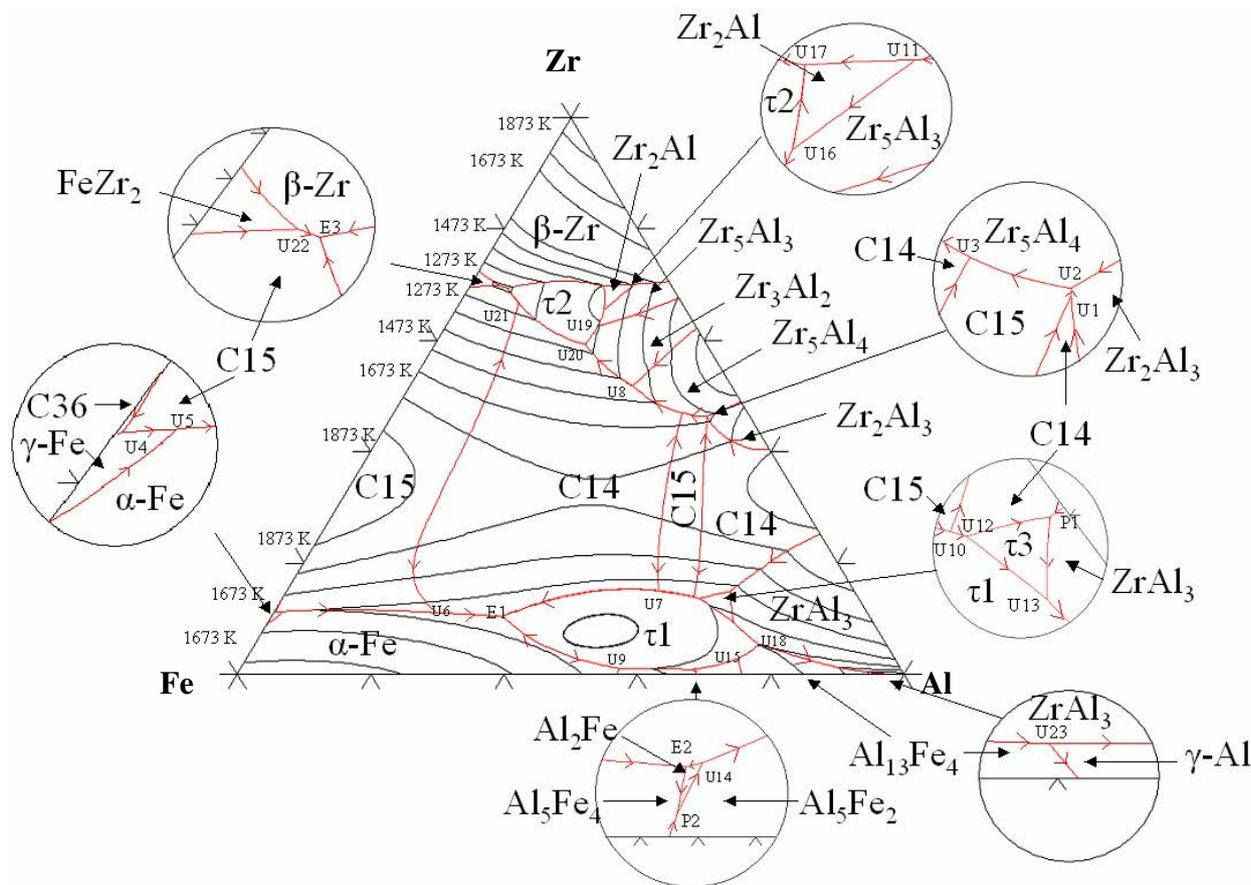
**Figure VI - 8 - Surfaces de solidification primaire du diagramme de phase ternaire Fe-Al-Zr, présentant la nappe de liquidus ainsi que les réactions invariantes. Le sens de décroissance de la température le long des lignes monovariantes est indiqué par des flèches. Les réactions invariantes sont également indiquées.**
