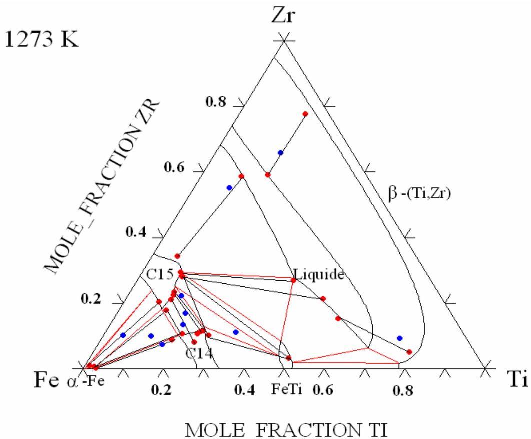
**Figure VI - 13 -section isotherme à 1273 K calculée présentant les conodes mesurées expérimentalement. Les points rouges représentent les limites de solubilité des phases et les points bleus représentent les compositions mesurées.**
