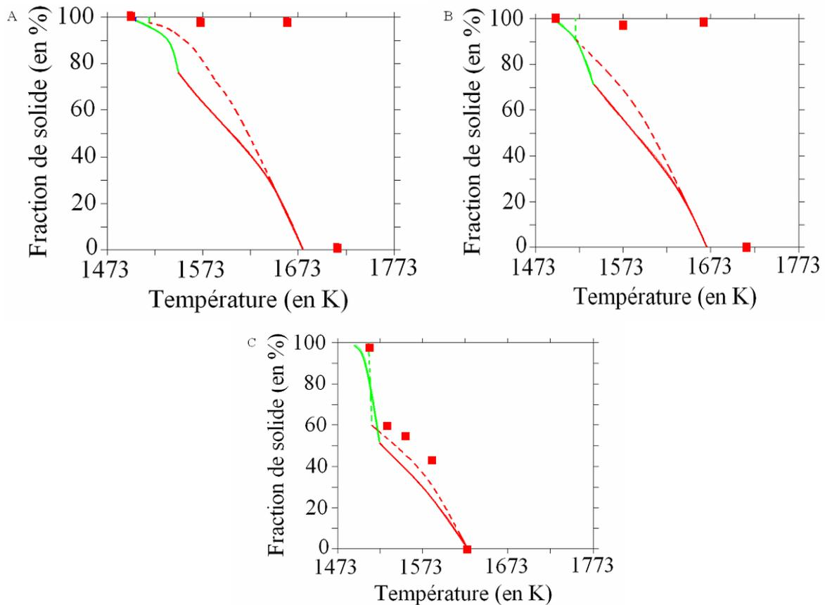
**Figure VI – 22 – Séquences de solidification des trois alliages quaternaires Fe-25Al-5Ti-xZr ( $x = 0,5[A] / 1[B] / 3[C]$ ) calculées à partir de la base de données thermodynamiques selon le modèle de Gulliver-Scheil (traits pleins) ou du bras de levier (pointillés). Les points correspondent aux mesures correspondantes de fraction solide effectuées sur les barreaux de TSD.**
