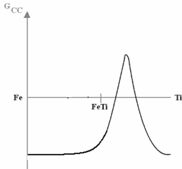
**Figure VI - 10 - Schéma présentant l'évolution de la courbe d'énergie de Gibbs de la solution solide cubique centrée le long de l'axe binaire Fe-Ti présentant la lacune de miscibilité dans le coin riche en titane.**
