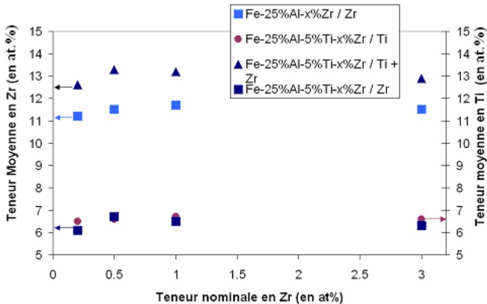
**Figure III - 20 – Variation des teneurs moyennes en Ti, en Zr et en Ti+Zr en fonction de la teneur nominale en zirconium dans les agrégats eutectiques des alliages ternaires et quaternaires. L'incertitude sur les mesures est de l'ordre de +/-0,25 at. %.**
