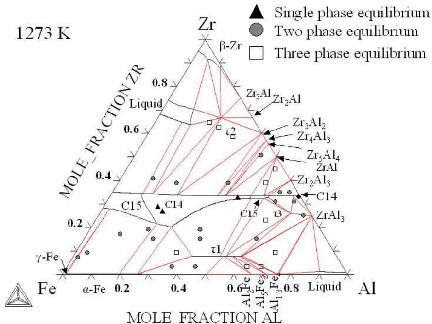
Figure VI - 4 - Section isotherme calculée à 1273 K du système ternaire Fe-Al-Zr, comparée aux données d'équilibres de phases déterminées expérimentalement symbolisées par  $\circ$ ,  $\Delta$  et  $\square$ .
