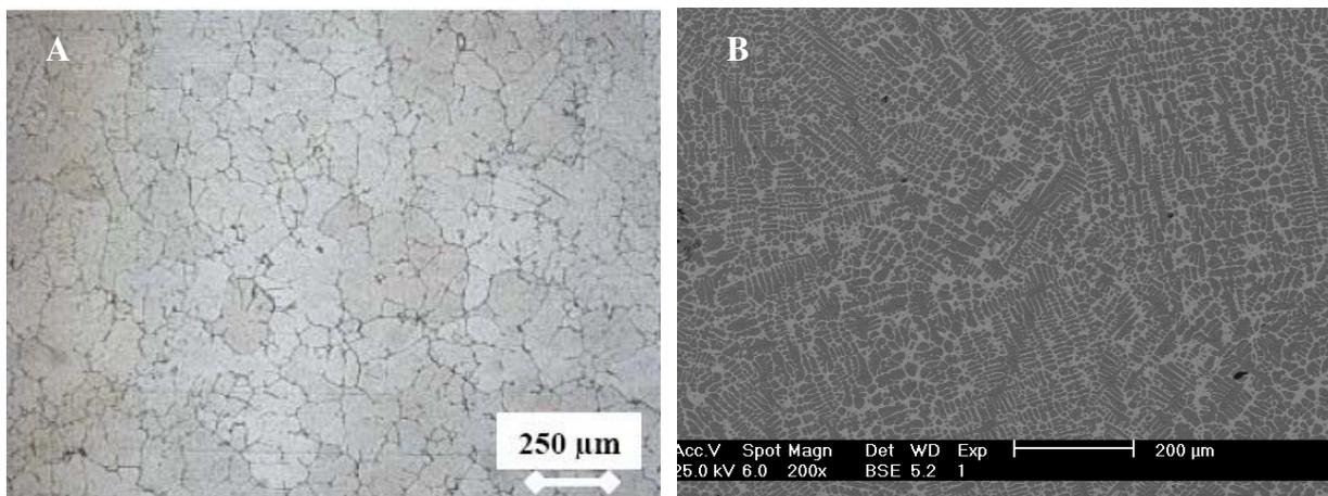
Figure III - 5 – Micrographie optique de l'alliage Fe-25Al-3Zr (A) et micrographie MEB en mode BSE à faible grandissement illustrant le caractère dendritique des alliages ternaires Fe-Al-Zr.
