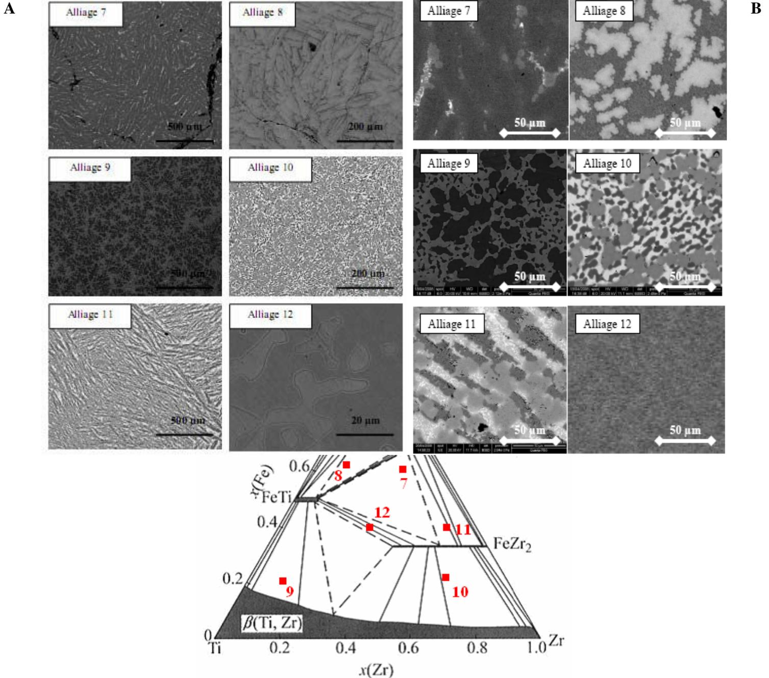
Figure V - 19 - Micrographies des alliages 7 à 12 maintenus à 1273 K pendant 30 minutes (9, 10 et 12) ou 24 heures (7, 8 et 11) puis trempé à l'eau salée.
