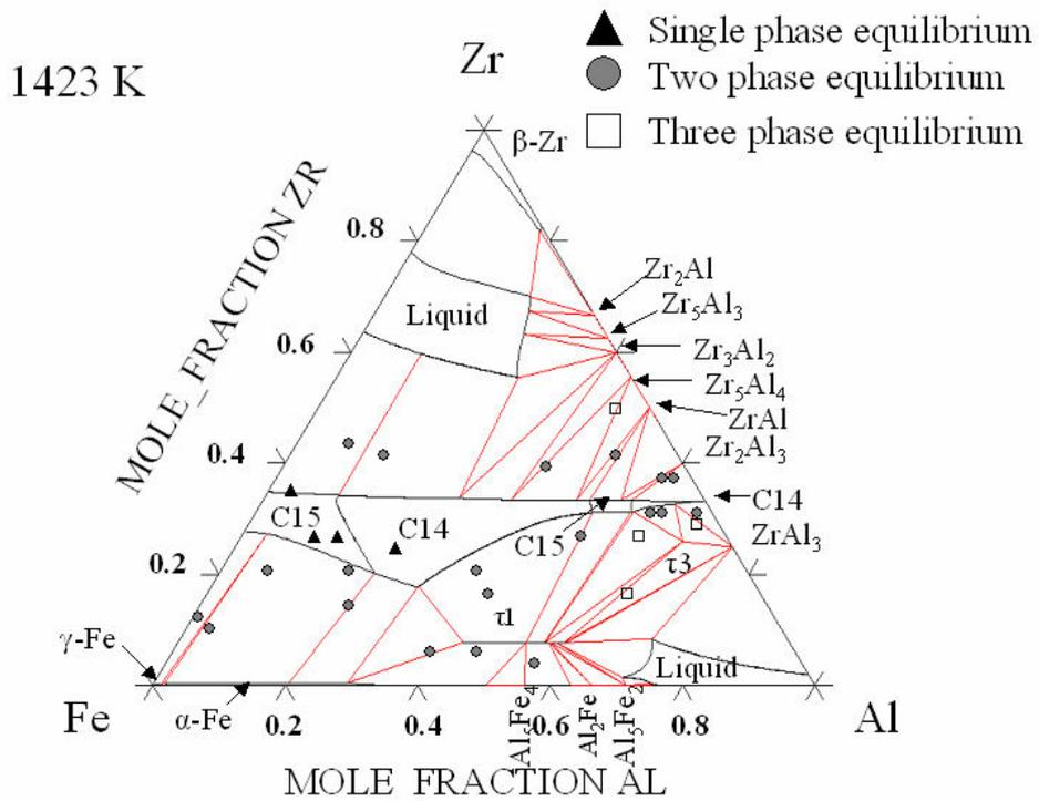
Figure VI - 5 - Section isotherme calculée à 1423 K du système ternaire Fe-Al-Zr, comparée aux données d'équilibres de phases déterminées expérimentalement symbolisées par  $\circ$ ,  $\Delta$  et  $\square$ .
