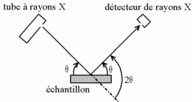
Figure II - 9 - Schéma du montage  $\theta$ - $2\theta$  de diffraction des rayons X.
