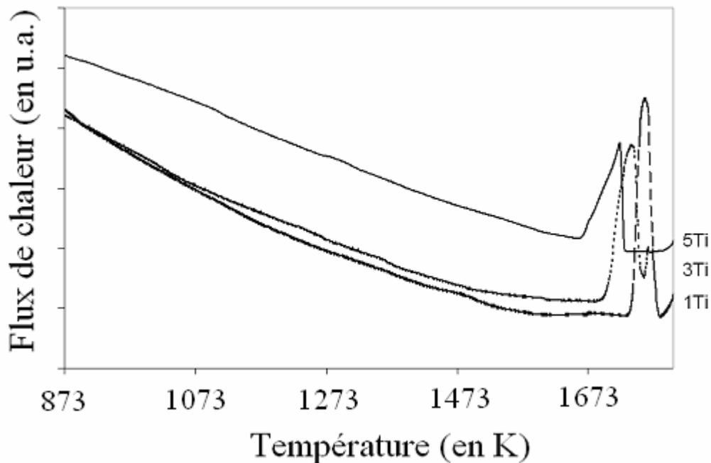
**Figure V - 2-Résultats d'analyse thermique différentielle des alliages de la famille Fe-Al-Ti lors de la solidification.**
