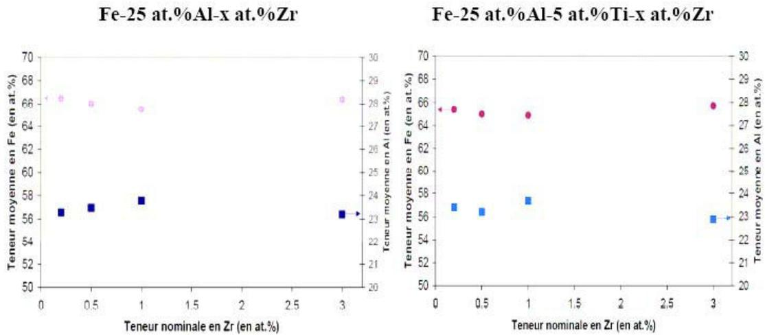
Figure III - 18 - Teneur moyenne en fer et en aluminium dans les agrégats eutectiques en fonction de la teneur nominale en zirconium des alliages ternaires et quaternaires bruts de solidification. L'incertitude sur les mesures est de l'ordre de +/-0,25 at. %.
