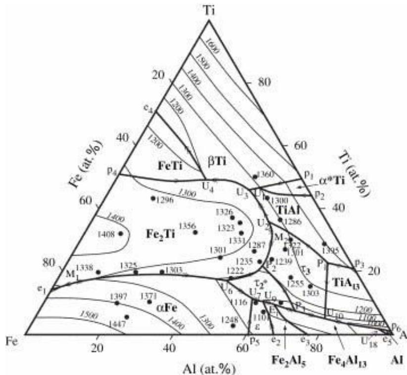
Figure IV- 15– Nappes de liquidus du système Fe-Al-Ti corrigée par Palm et Lacaze [PAL2006].
