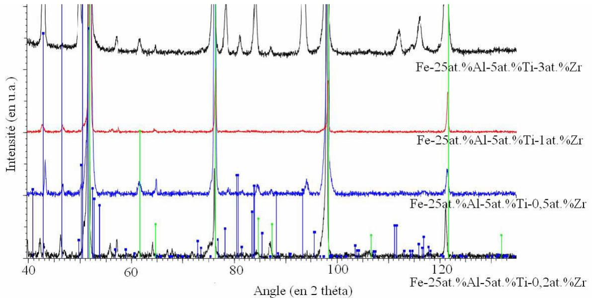
**Figure III - 13 - Diffractogrammes des rayons X des alliages quaternaires Fe-Al-Ti-Zr présentant une teneur en zirconium variable. Les traits verticaux verts illustrent les pics identifiés de la solution solide ferritique basée sur la stœchiométrie  $Fe_3Al$  et les pics bleus illustrent la position identifiée des pics de la phase de Laves hexagonale de structure C14.**
