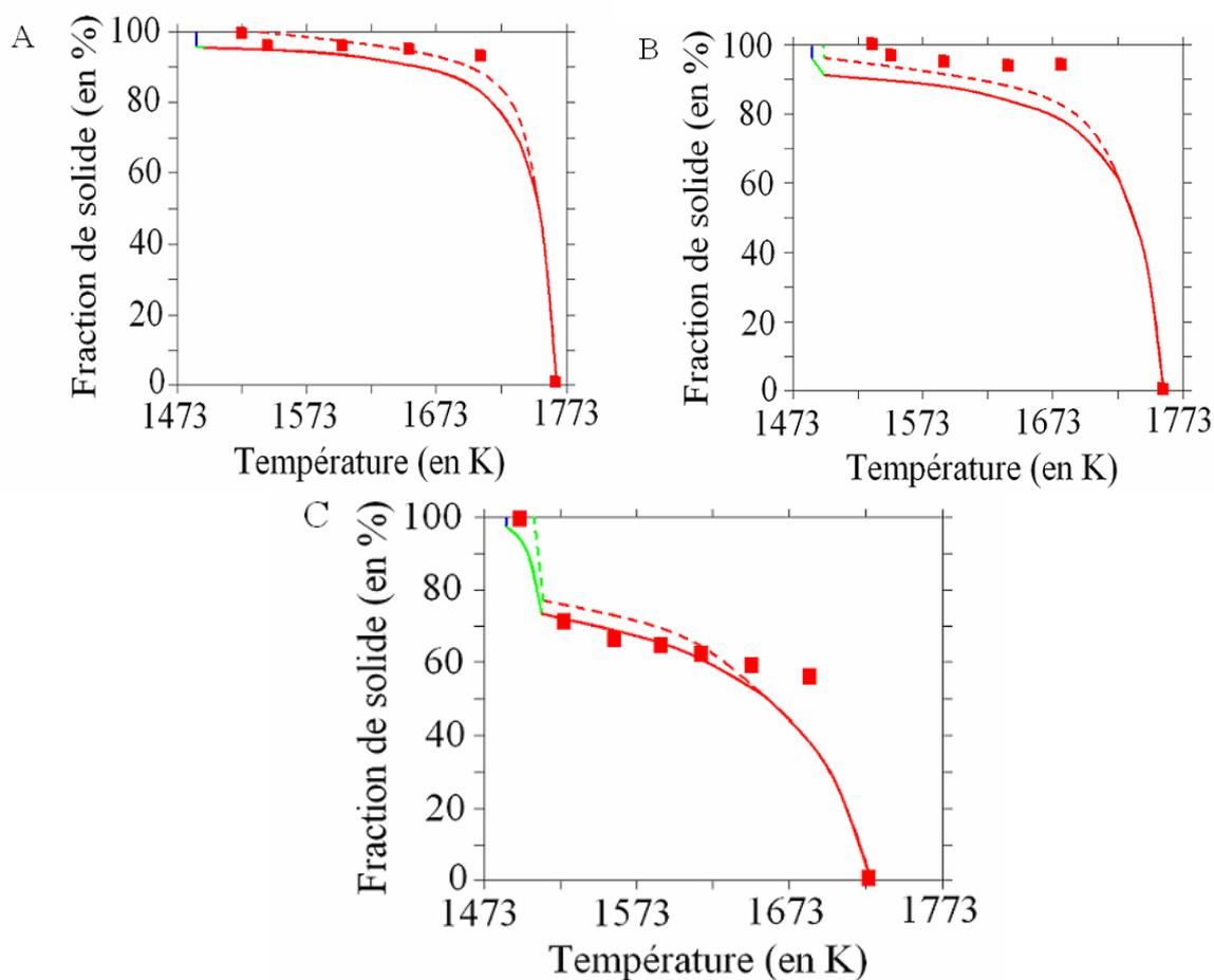
**Figure VI - 19 – Séquences de solidification des trois alliages ternaires Fe-25Al-xZr ( $x = 0,5[A] / 1[B] / 3[C]$ ) calculées à partir de la base de données thermodynamiques selon le modèle de Gulliver-Scheil (traits pleins) ou du bras de levier (pointillés). Les points correspondent aux mesures correspondantes de fraction solide effectuées sur les barreaux de TSD.**
