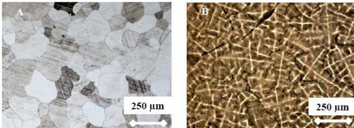
Figure III - 3 - Micrographies optiques de l'alliage n°1 après différentes attaques (A : Réactif de Kroll et B : 75% H<sub>2</sub>O + 5% HF + 20% HNO<sub>3</sub>).
