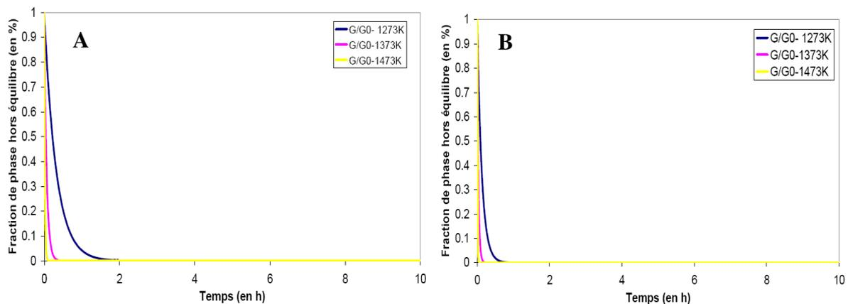
**Figure V - 7 - Evolution de la fraction de phase hors équilibre calculée à l'aide du modèle de Flemings [FLE1974] en considérant le fer (A) et l'aluminium (B) comme élément limitant la diffusion.**
