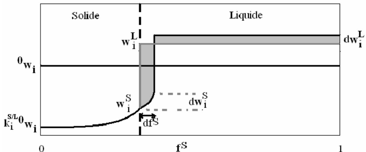
Figure A4 - 2 - Profil de concentration en cours de solidification dans les conditions de diffusion parfaite dans le liquide et de diffusion nulle dans le solide (conditions d'équilibres). Cas où  $k_i^{S/L} \ll 1$ .
