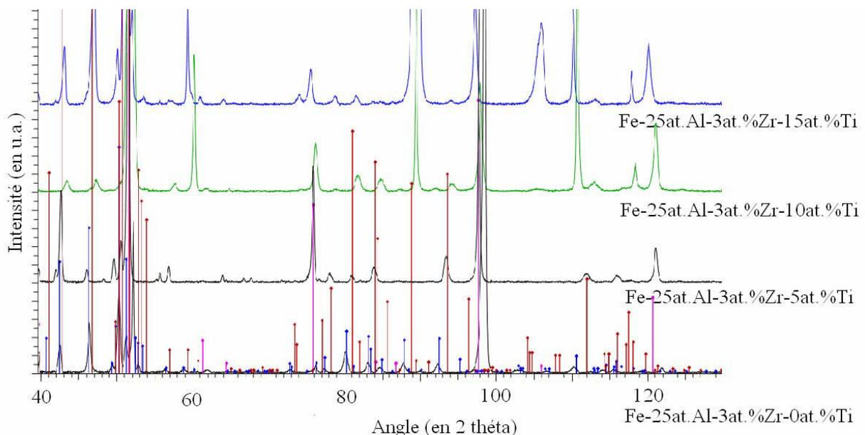
**Figure III - 14 - Diffractogrammes des rayons X des alliages quaternaires Fe-Al-Ti-Zr présentant une teneur en titane variable. Les traits verticaux violets illustrent les pics identifiés de la solution solide ferritique basée sur la stœchiométrie  $Fe_3Al$  et les pics bleus et rouges illustrent la position identifiée des pics de la phase de Laves hexagonale de structure C14 pour l'alliage ternaire et dans les alliages quaternaires respectivement.**
