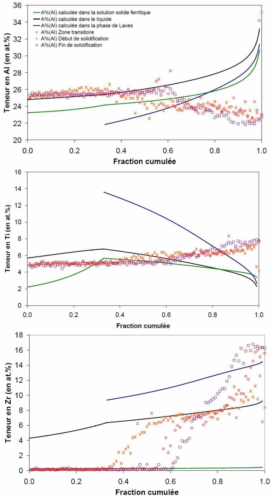
**Figure VI - 23 - Comparaison des teneurs calculées (trait plein) et mesurée (pointillés) en éléments majoritaires (Fe, Al et Ti) dans les bras de dendrites de phase primaire au cours de la solidification d'un alliage présentant 3 at.% de zirconium et 5 at.% de titane.**
