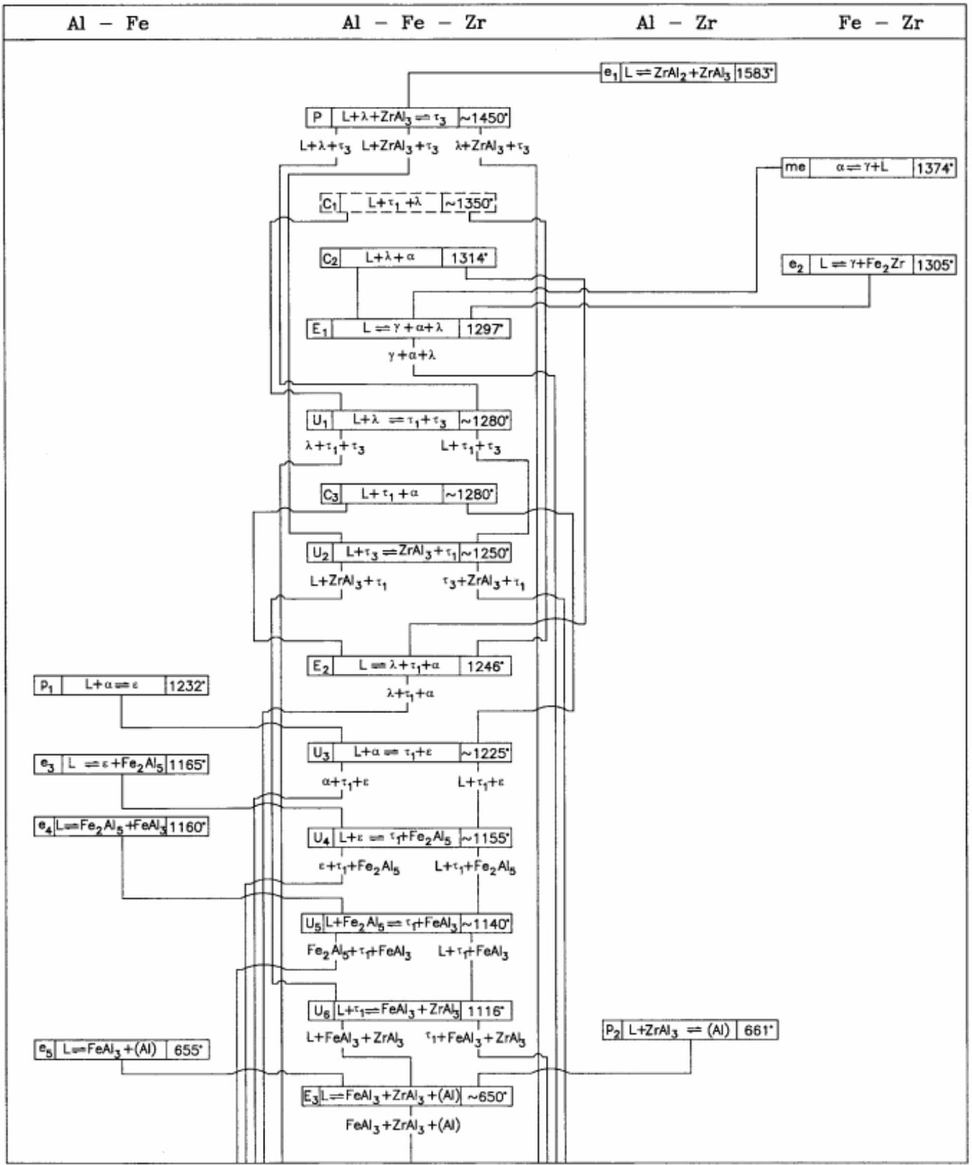
Figure IV- 20 – Schéma synoptique des réactions invariants envisageables lors du processus de solidification des alliages présentant une faible teneur en zirconium [RAG2006].
