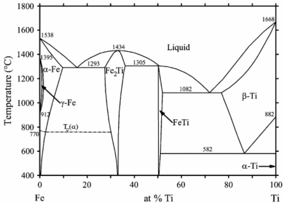
Figure IV- 10– Diagramme binaire Fe-Ti calculé par Kumar [KUM1999].
