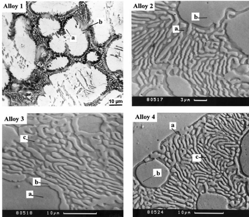
**Figure I - 11 – Micrographies d’alliages du coin riche en fer du système Fe-Al-Ti présentant la microstructure brute de solidification. Les phases identifiées sur les micrographies sont les suivantes : a =  $\alpha$ -Fe, b = Fe<sub>2</sub>Ti et c = Fe<sub>2</sub>AlTi (structure ordonnée L2<sub>1</sub>) [PRA2001].**
