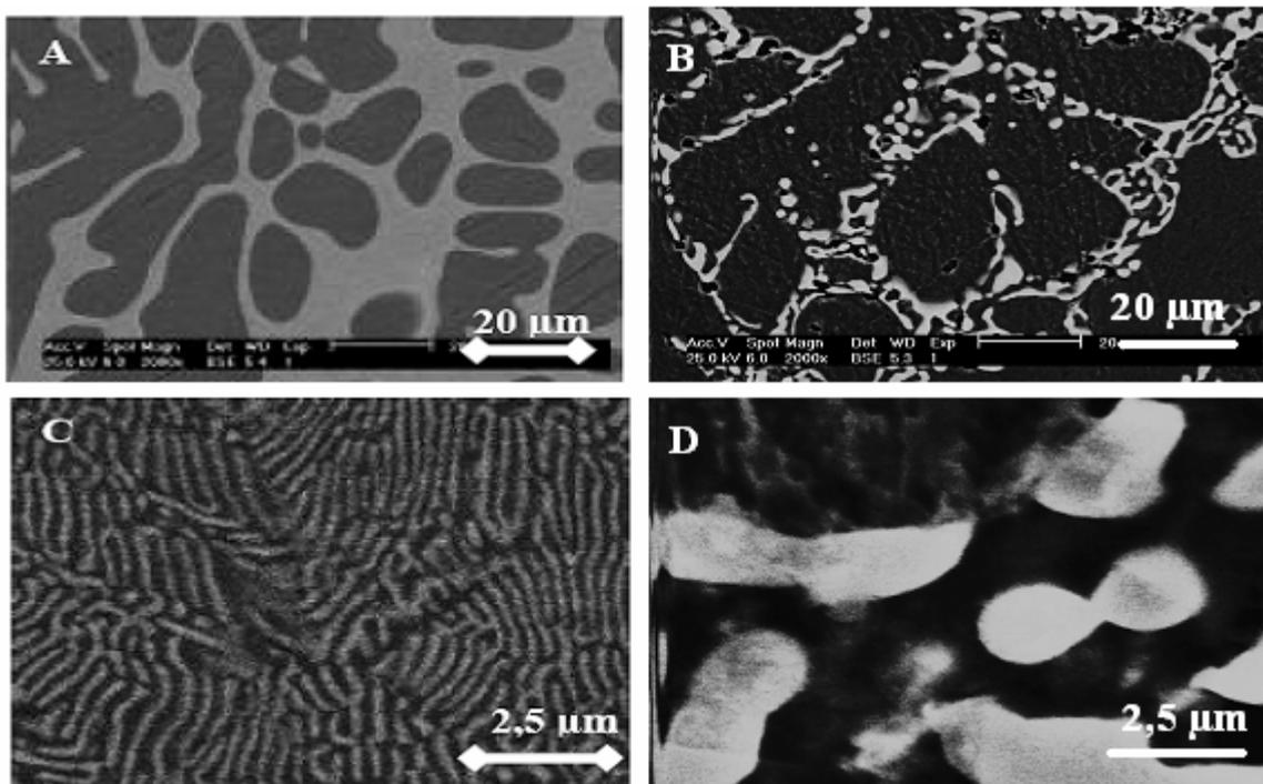
Figure V - 9 - Comparaison des structures lamellaires des eutectiques de l'alliage Fe-25Al-5Ti-3Zr avant (A) et après (B) maintien isotherme à 1273 K pendant 8 heures, observés par microscopie électronique à balayage en mode électrons rétro-diffusés (A et B : grossissement x 2000; C et D : grossissement x 6000).
