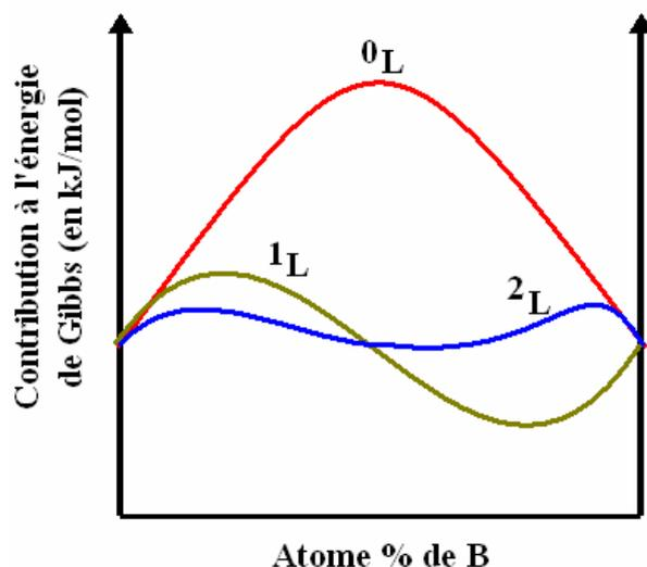
Figure IV- 1– Influence de l'ordre du paramètre  ${}^v L_{i,j}^\alpha$  sur le terme d'énergie de Gibbs en excès.
