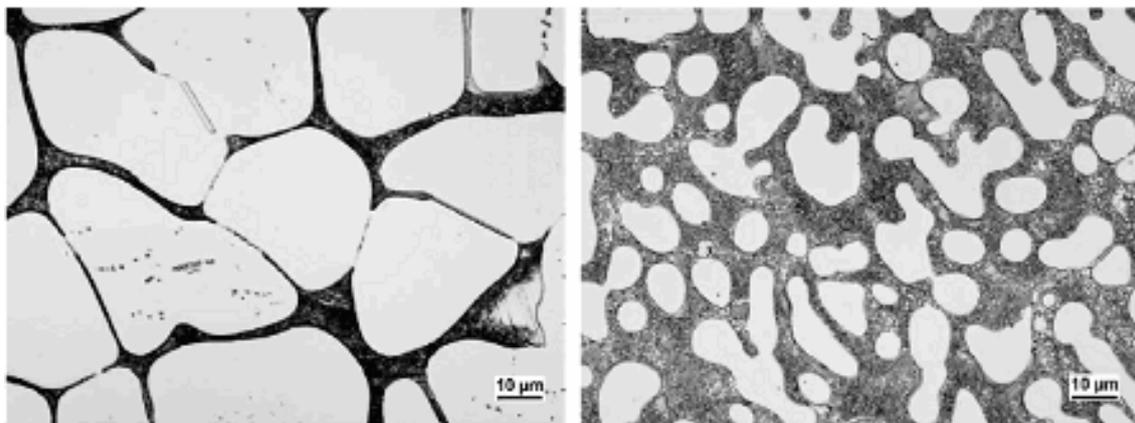
**Figure I - 9 - Micrographies optiques de microstructures brutes de solidification représentatives des alliages étudiés par Stein et al [STE2005].**
