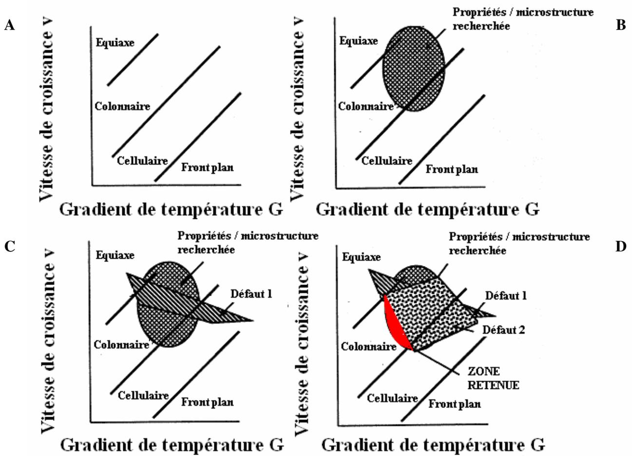
Figure I - 1 - Carte de coulabilité d'un alliage mis en forme par solidification dirigée [SEK1991].
