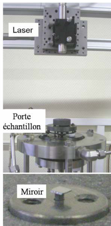
Figure II.27. Photographies du montage à température ambiante. a) interféromètre 1D avec l'utilisation d'un miroir, b) interféromètre 2D.
