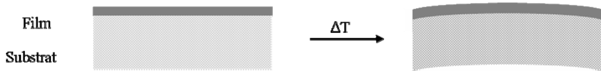
Figure I. 15. Représentation schématique de la courbure du substrat.
