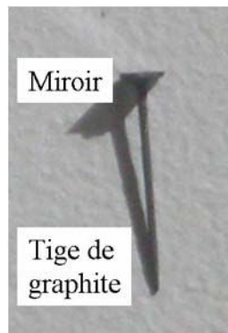
Figure II.36. Photographie du miroir de silicium collé sur une tige de graphite d'un diamètre de 0,5 mm : ce miroir est utilisé pour mesurer la déflexion des films par interférométrie 1D.
