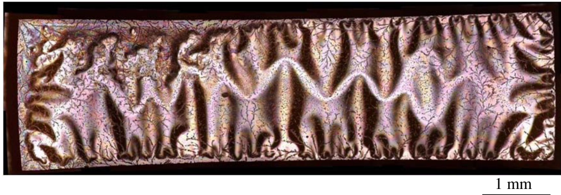
Figure II.14. Micrographie optique d'une bicouche silicium/oxyde de silicium obtenue en combinant deux techniques de gravure (DRIE/KOH). On note un flambage important dû à la présence d'une contrainte en compression.
