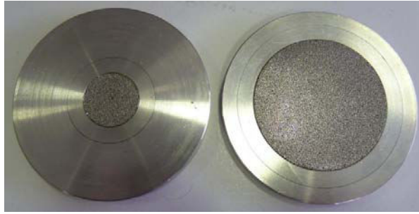
Figure II.4 : Photos de frittés de 2cm et de 5cm de diamètre
