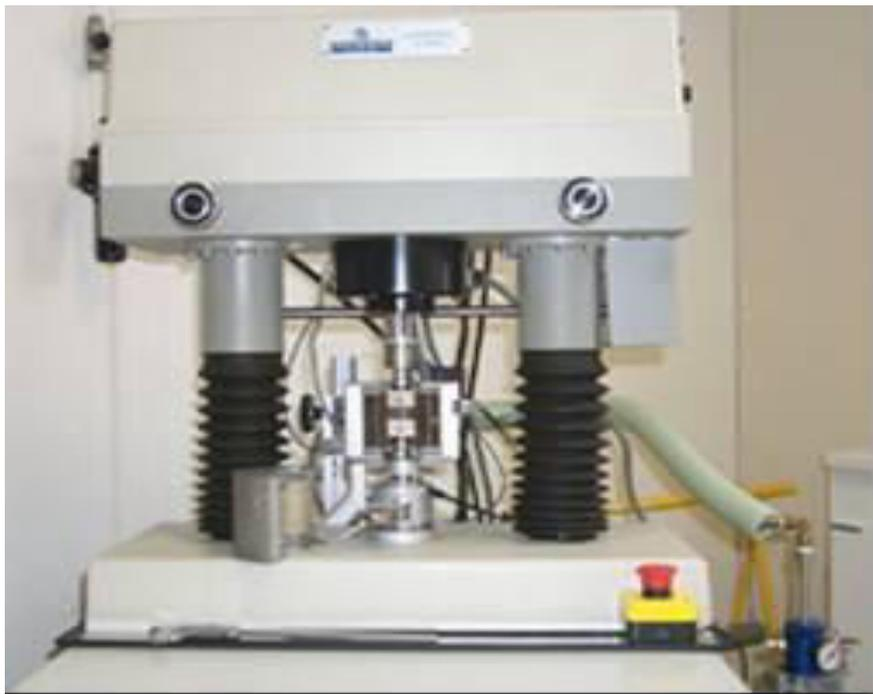
**Figure 2.4** : Viscoanalyseur Metravib AV2000
